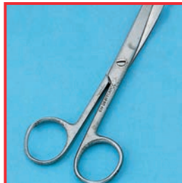
Schere mit Lochkorrosion
