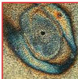
Beispiel für Lochkorrosion
