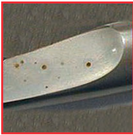
Chloridinduzierte Lochkorrosion auf dem Instrument.
