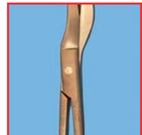
Beizangriff der Instrumentenoberfläche. Ursache: Säureangriff wegen Überdosierung.
