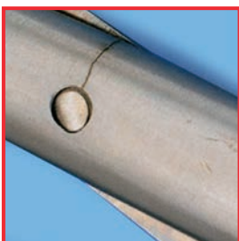
Spannungsrisse im Gewindebereich einer Schere
