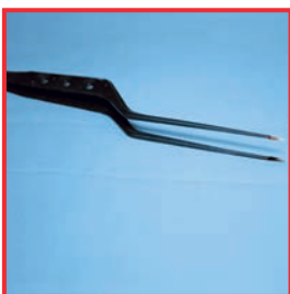
Verformung durch unsachgemäße Handhabung
