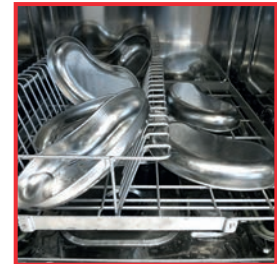
Falsche Beladung/umgekippte Nierenschalen
