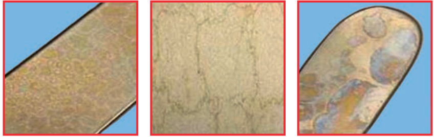
Typische Silikatverfärbungen auf der Instrumentenoberfläche nach der Dampfsterilisation durch zu hohen Kieselsäuregehalt im VE-Wasser.
