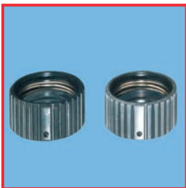
Bildseite rechts: Materialangriff des Schwarzeloxals durch enthärtetes Wasser.
