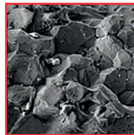
Detail: Maulbruch-Klemme mit typischer körniger, inter- kristalliner Bruchstruktur.
