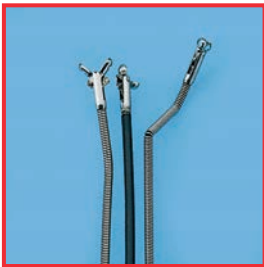
Gewaltsam beschädigte Biopsie zangen
