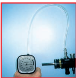
Manueller Dichtigkeitsstest bei einem flexiblen Endoskop
