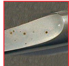
Beispiel für Lochkorrosion
