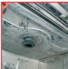
Spülkammer mit starkem Kalkbefall
