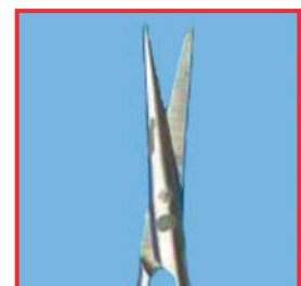
Partieller Beizangriff und Ablagerungen eines Ätzmittels zur Blutstillung auf der Instrumentenoberfläche. Ursache: zu lange Kontaktzeit
