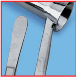
Verfleckungen auf Grund hohen Salzgehalts im Nachspülwasser
