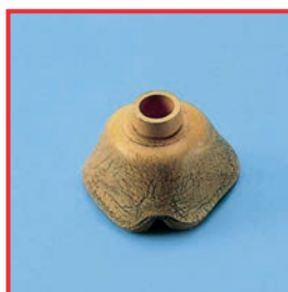
Alterungsrisse an einer Atemmaske
