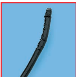
Aufquellung am Distalende eines Fiberskops
