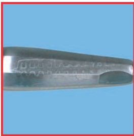
Verschleppung von Reinigungsmittelrückständen durch unzureichende Spülung
