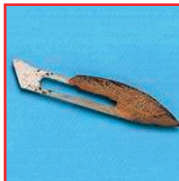
Materialangriff der Klingeoberfläche wegen Feuchte. Ursache: Werkstoffzusammensetzung, Normalstahl da Einmalprodukt.
