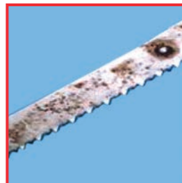
Materialangriff der partiell defekten Chromschicht. Ursache: Feuchte führt zu Rostbildung des ungeschützten Trägerwerkstoffes aus Normalstahl
