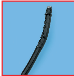
Aufquellen eines Einführungs-schlauches durch Verwendung eines ungeeigneten Pflegemittels.
