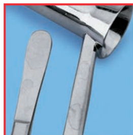
Folge: Instrumente mit Kalkrückständen
